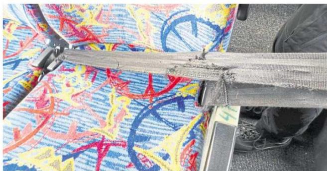
Unhaltbare Zustände in einem Reisebus, den die Polizei auf der A 61 bei Dieblich gestoppt hat. Auch die Sicherheitsgurte wiesen erhebliche Defekte auf. Foto: Polizei Koblenz
