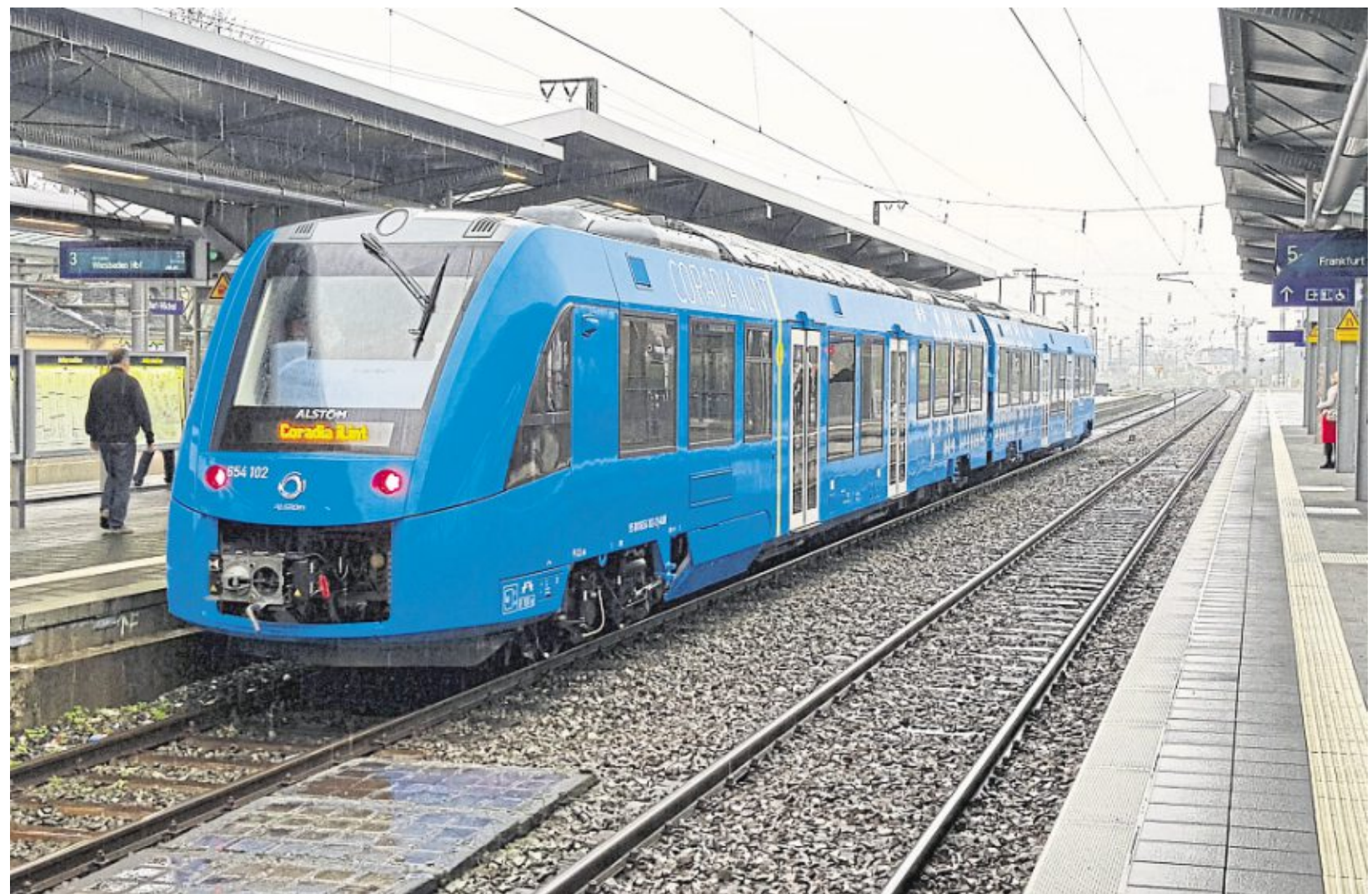
Moderner Nahverkehr unterscheidet sich deutlich von den Vorhersagen aus Bendorf: Mit Wasserstoff und Brennstoffzellen elektrisch angetriebene Fahrzeuge wie der abgebildete iLint von Alstom fahren emissionsfrei und produzieren lediglich Wasser. Der SPNV-Nord möchte solche Triebwagen ab 2024 über mehrere Jahre an der Ahr sowie zwischen Eifel und Lahn erproben.
